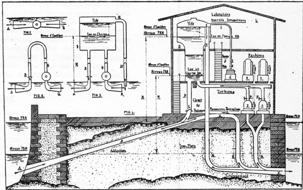
Schéma d'une installation type du Béliersiphon maritime à chambre barométrique. (Fig. 6.)
